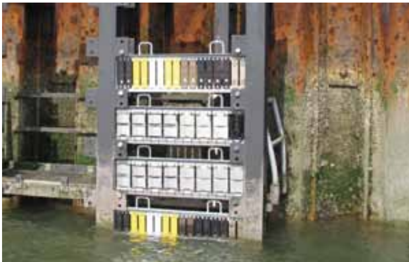
Auslagerungsversuche verschiedener Korrosionsschutzlösungen im Rahmen des Projekts »BestKorr«, gefördert durch das PFAU-Programm
