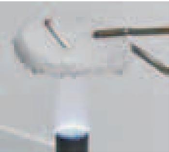
Optimales Brandverhalten: Aufgeschäumte Papierstaubplatte in der offenen Bunsenbrennerflamme
