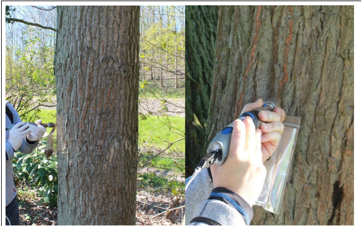
Abb. 9: Standardisierte Entnahme der äußeren Rinde zum Luftgüte-Rindenmonitoring mit dem Rindenprobenehmer (Standort RM1)
