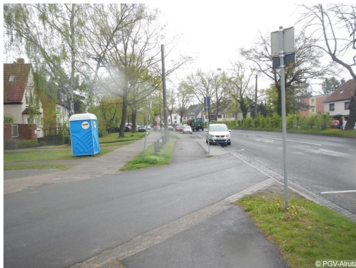
Bild 7-8 Fehlende Radverkehrsfurt am Radweg Grambker Heerstraße
