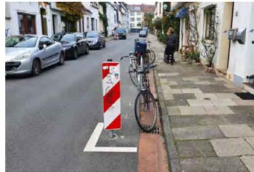
Abb. 16 | Pagentorner Straße: vorher beidseitiges, regelwidriges Gehwegparken, jetzt freie Gehwege. Fahrradbügel parallel zum Bordstein verhindert Falschparken und reduziert den Überwachungsaufwand.
