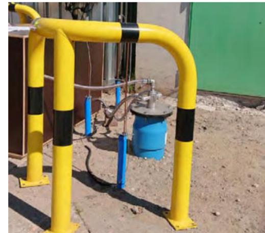
Abb. 03 | Versuchseinrichtung zur Einbringung thermischer Energie zur Mobilisation von Ölphasen
