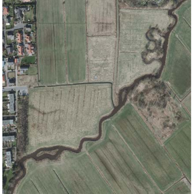
Zur Strukturverbesserung und zum besseren Niederschlagswasserrückhalt wurden 2007 zwei Nebenarme angelegt (© GeoBasis-DE / GeoInformation Bremen 2017)
