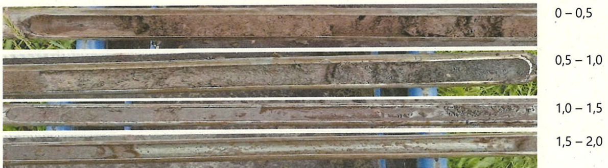
Bild 6: Bohrung B 3 (von links nach rechts); Mittelsand, schwach schluffig, schwach kiesig, schwach humos (dunkelbraun), bis ca. 0,4 m unter GOK; Schluff, schwach sandig (grau), bis ca. 0,55 m unter GOK; Mittelsand, grobsandig, sehr schwach kiesig (braun-grau), grundwasserführend, bis mind. 2 m u. GOK.
