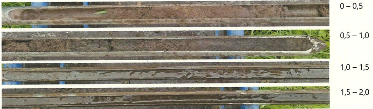
Bild 5: Bohrung B 2 (von links nach rechts); Mittelsand, schwach schluffig, schwach grobsandig, schwach humos (dunkelbraun), bis ca. 0,6 m unter GOK; Mittelsand, schwach grobsandig, humos (dunkelbraun), bis ca. 1 m unter GOK; Mittelsand, grobsandig, grundwasserführend (dunkelbraun), bis mind. ca. 2 m unter GOK.
