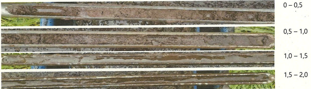
Bild 11: Bohrung B 8 (von links nach rechts): Mittelsand, schwach schluffig, schwach grobsandig, schwach humos (braun – dunkelbraun), bis ca. 0,7 m unter GOK; Sand, schluffig, humos (braun – dunkelbraun), bis ca. 0,88 m unter GOK; Schluff, sandig, (dunkelbraun – grau), grundwasserführend, bis ca. 0,9 m unter GOK; Mittelsand, schwach kiesig (braun), bis mind. 2 m unter GOK.
