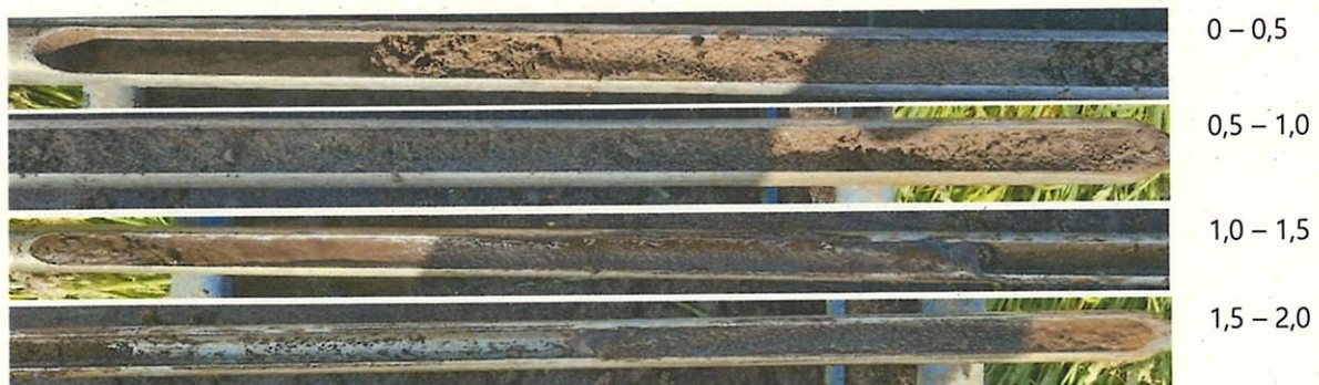
Bild 13: Bohrung B 10 (von links nach rechts): Mittelsand, schwach schluffig, schwach grobsandig, schwach humos (braun), bis ca. 1,0 m unter GOK; Mittelsand, schwach grobsandig, schwach humos (braun – dunkelbraun), grundwasserführend, bis mind. ca. 2 m unter GOK.
