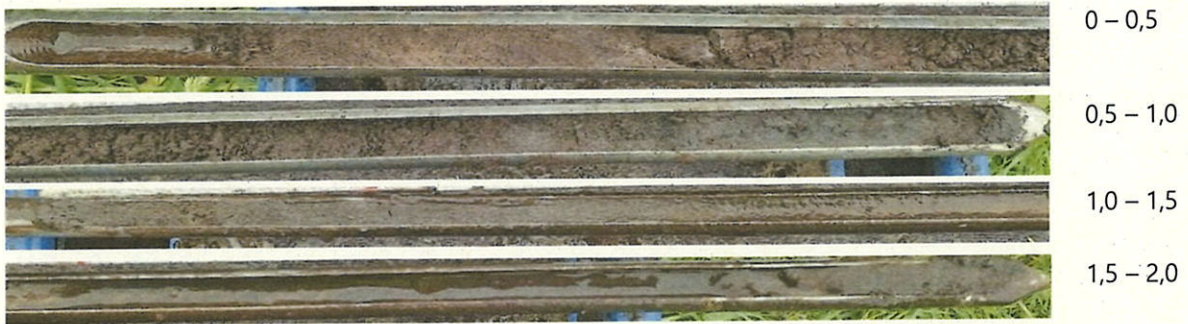
Bild 8: Bohrung B 5 (von links nach rechts): Mittelsand, schwach schluffig, schwach grobsandig, schwach humos (dunkelbraun), bis ca. 0,85 m unter GOK; Schluff, sandig (grau), bis ca. 1 m unter GOK; Mittelsand, grobsandig, sehr schwach kiesig (braun), grundwasserführend, bis mind. 2 m unter GOK.
