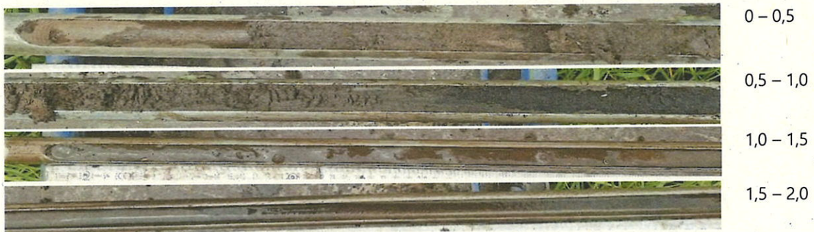
Bild 9: Bohrung B 6 (von links nach rechts): Mittelsand, schwach schluffig, schwach humos (braun), bis ca. 0,44 m unter GOK; Schluff, schwach sandig, schwach humos (grau – braun), bis ca. 0,8 m unter GOK; Mittelsand, grobsandig, sehr schwach kiesig (dunkelbraun), grundwasserführend, bis mind. ca. 2 m unter GOK.
