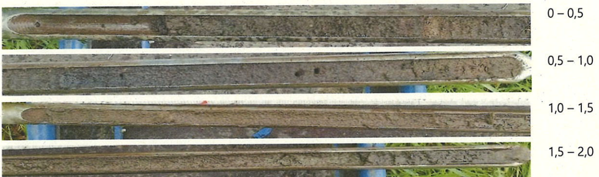
Bild 4: Bohrung B 1 (von links nach rechts): Mittelsand, schwach schluffig, humos (dunkelbraun), bis ca. 0,9 m; Mittelsand, schwach kiesig, schwach humos (braun – hellbraun), bis ca. 1,6 m unter GOK; Mittelsand, grobsandig, schwach kiesig (braun – hellbraun), bis mind. ca. 2 m unter GOK.
