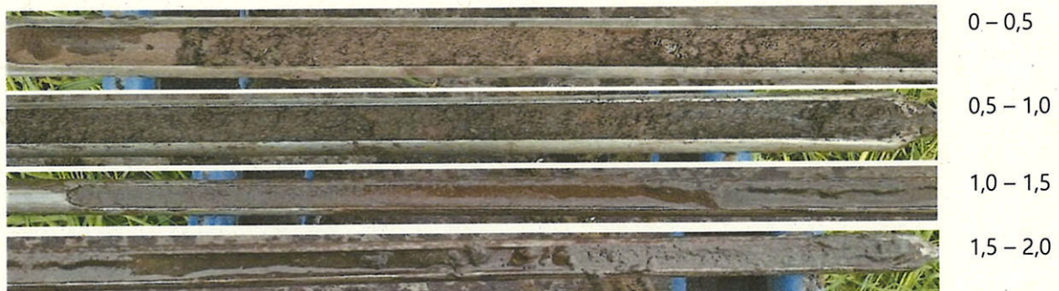
Bild 7: Bohrung B 4 (von links nach rechts): Mittelsand, schwach schluffig, schwach humos (dunkelbraun), bis ca. 0,6 m unter GOK; Mittelsand, schluffig, humos (dunkelbraun), bis ca. 0,76 m unter GOK; Schluff, schwach sandig (grau), grundwasserführend, bis ca. 0,93 m unter GOK; Mittelsand, grobsandig, sehr schwach kiesig, bis mind. 2 m unter GOK.
