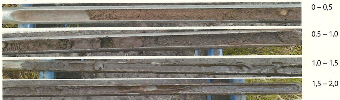
Bild 10: Bohrung B 7 (von links nach rechts): Mittelsand, schwach schluffig, schwach grobsandig (braun – dunkelbraun), bis ca. 0,5 m unter GOK; Schluff, sandig (grau), bis ca. 0,8 m unter GOK; Mittelsand, schwach grobsandig, sehr schwach kiesig (dunkelbraun), grundwasserführend, bis mind. 2 m unter GOK.
