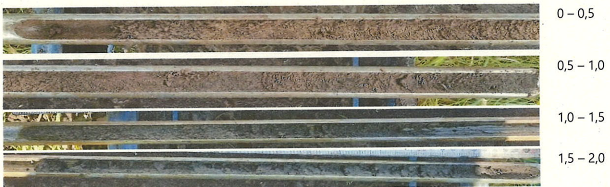
Bild 12: Bohrung B 9 (von links nach rechts): Mittelsand, schwach schluffig, sehr schwach humos (braun), bis ca. 1 m unter GOK; Mittelsand, schwach grobsandig, sehr schwach kiesig (braun – dunkelbraun), bis mind. 2 m unter GOK.
