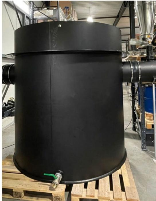
Bild 4-1: In PE-HD-Schacht eingebauter Hydroshark am Teststand
