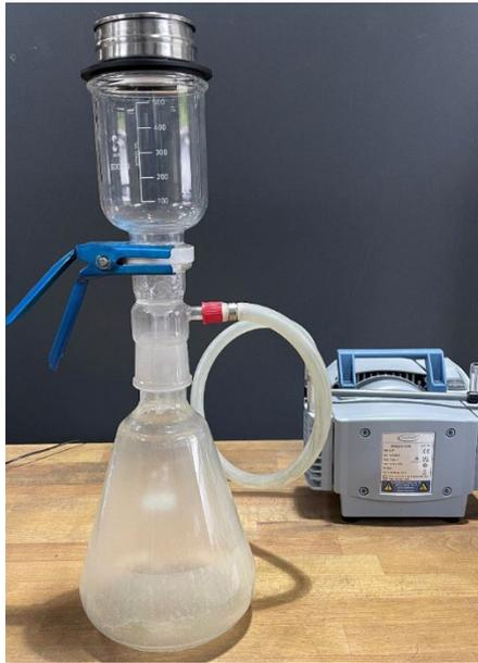
Bild 4-8: Sieb-/Vakuumfiltrationseinheit
