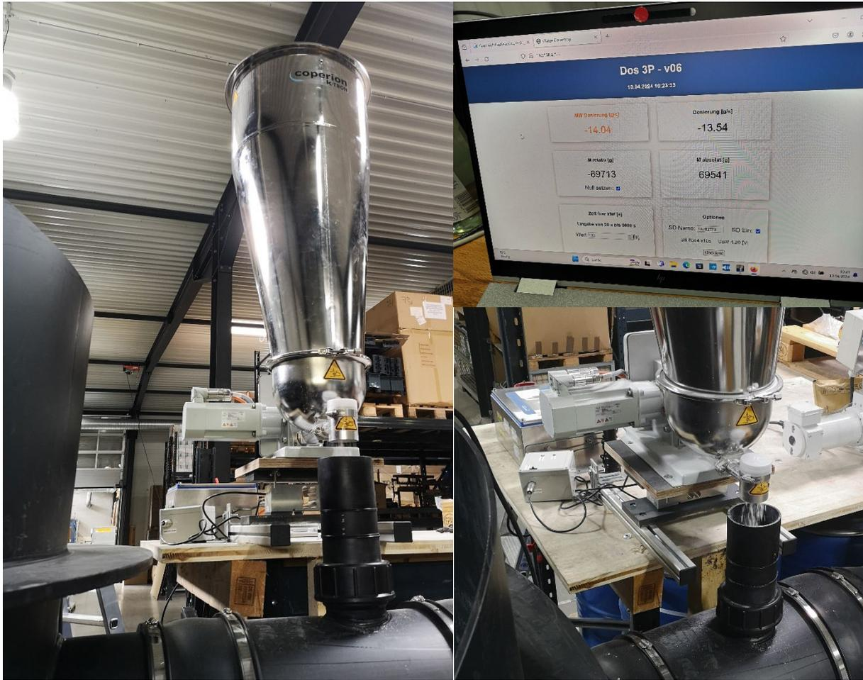
Bild 4-6: Schneckendosierer und Millisildosierung; Monitor zur Überprüfung des Millisil-Eintrags
