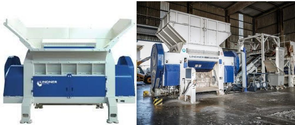
Abbildung 8: Links: Standard für Aufgabe; Rechts: geplante deutliche Erhöhung mit Möglichkeit einer Absaugung
