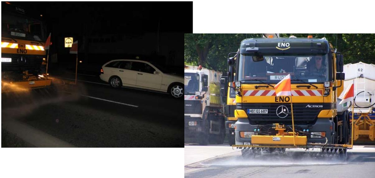
Abb. 2.2: Spülfahrzeug der Entsorgung Nord GmbH (ENO) Bremen beim Spülen (linkes Bild) in der Nacht vom 04.09. zum 05.09.2005 sowie beim Spültest (rechtes Bild)
