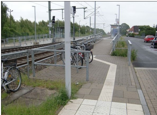
Abbildung 4: Die Zugänge zu den Bahnsteigen des Bahnhofs Bremen Turnerstraße sind über Rampen auf kurzem Weg barrierefrei vom Fußweg aus erreichbar.
