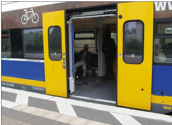
Abbildung 5: In Bremen-Walle ist das Ein- und Aussteigen in die Regio-S-Bahn mit nur einer kleinen Höhendifferenz zwischen dem Bahnsteig und der Trittschwelle des Fahrzeugs bequem möglich.
