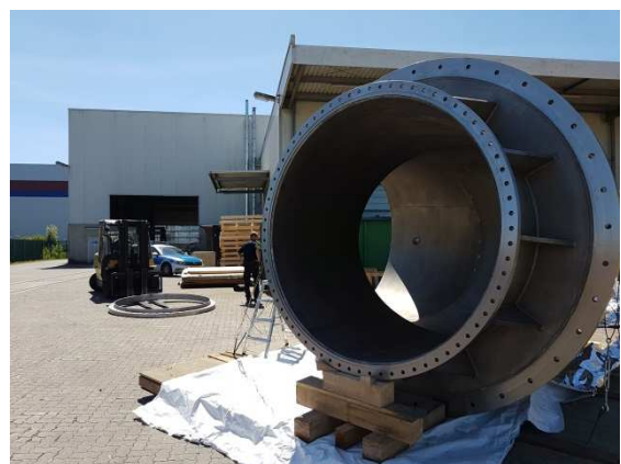
Krümmer, wo der Druckflansch verschraubt war
