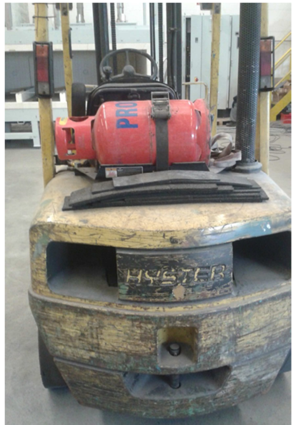
Mangelhafter flüssiggasbetriebener Gabelstapler
