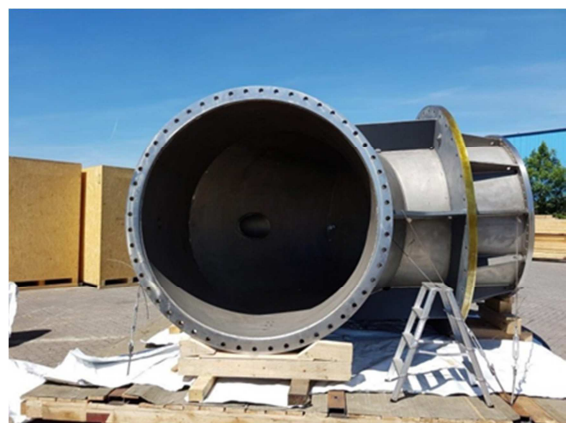
Krümmer, wo der Druckflansch verschraubt war
