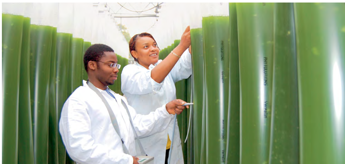
Zukunftsweisende Umwelttechnik: Meeresalgenproduktion der Firma phytolutions zur Klima schonenden Wiederverwertung von CO 2 , gekoppelt mit der Produktion von Energieträgern, Nahrungsmitteln und Chemikalien.
