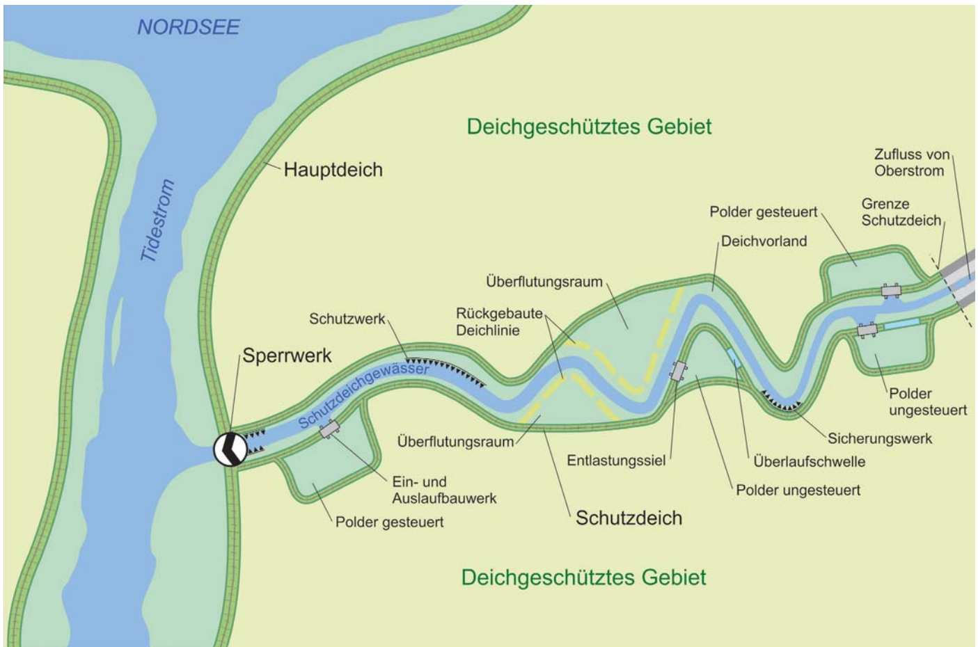
Abb. 4-2: Schutzdeichsystem (schematisch)
