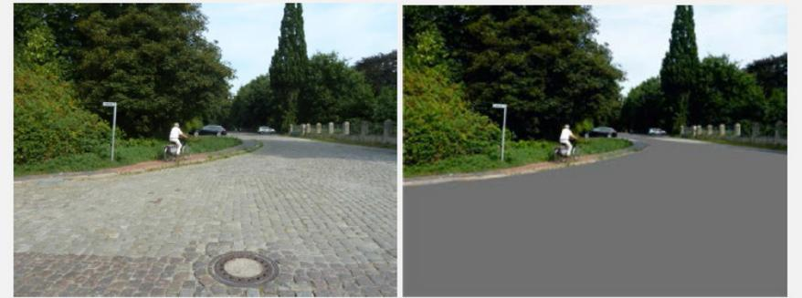
**Beispiele: Friedhofstraße** – aus städtebaulichen Gesichtspunkten ist der Erhalt des Kopfsteinpflasters nicht notwendig; durch einen Ersatz des Kopfsteinpflasters durch Asphalt könnte für Radfahrer der Fahrkomfort und die Sicherheit deutlich erhöht werden.
