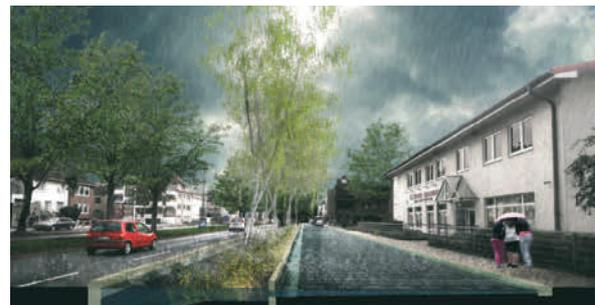
Abb. 22: Schaffung von Rückhalteräumen bei Starkregen durch Tiefbeet und tieferliegende Fahrbahn (MUST).
