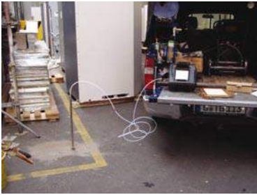
Abbildung 15: Beprobung der Bodenluft unterhalb eines Gebäudes
