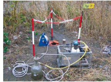
Abbildung 17: Entnahme einer Grundwasserprobe
