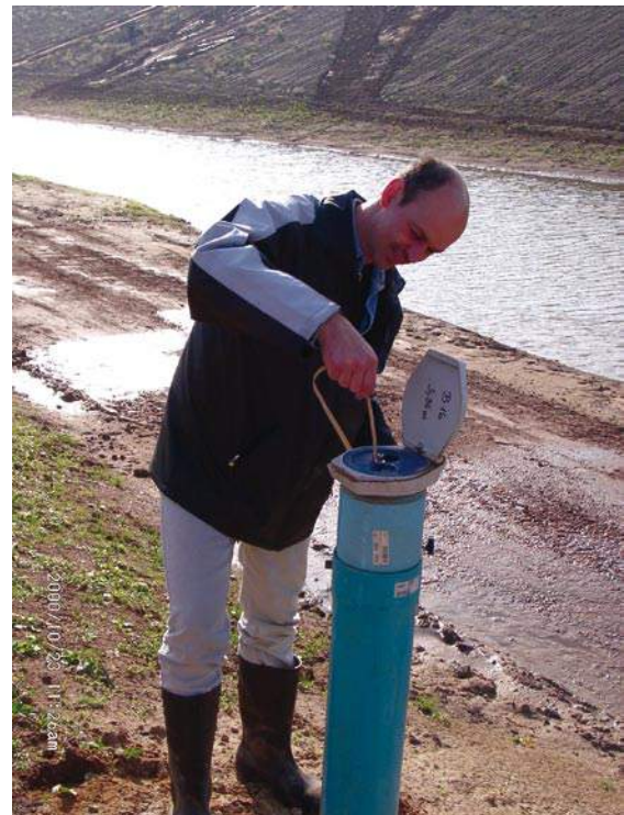
Abbildung 20: Messung des Grundwasserstands
