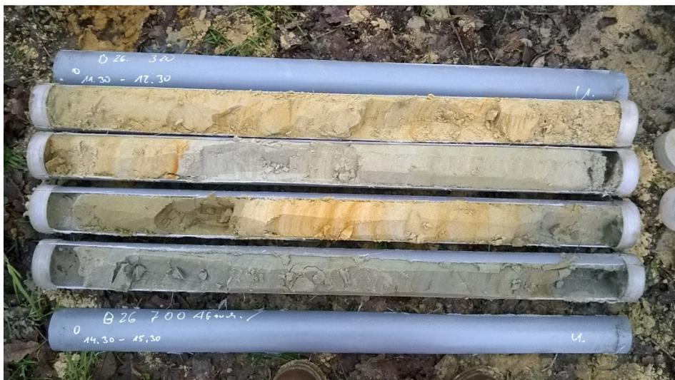
Abb. 11: Feinschichtung und Graufärbung bei LB 26:11,3 bis 15,3 m
