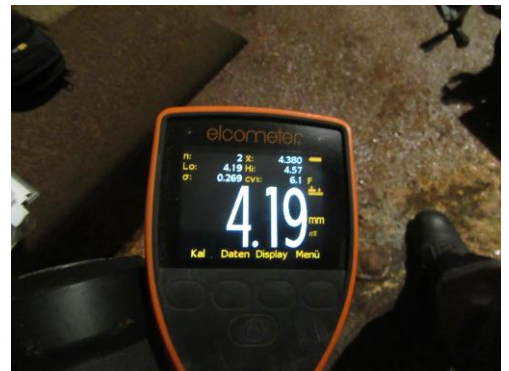
Messgerät zur Schichtdickenbestimmung.
