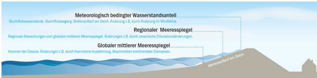
Abbildung 7: Schematische Darstellung der Faktoren, die Sturmflutwasserstände ändern können. Änderungen im globalen und regionalen Meeresspiegel beeinflussen sowohl die mittleren als auch die Sturmflutwasserstände. Änderungen im Windklima und Wellenauflauf sind nur für die Sturmflutwasserstände von Bedeutung. Zusätzlich zu den dargestellten Faktoren spielen gezeitenbedingte Änderungen eine Rolle. (Norddeutsches Klimabüro 2009) 30
