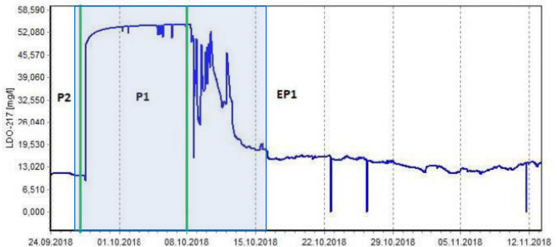
Abbildung 5: Sauerstoffgehalt [mg/l] der ersten Multisonde, P2 bis 27.09.18, P1 27.09 – 08.10.18, EP1 08.10 – 13.11.18 (Blau= pH-Wert Stabilisierung, grün= Pegelwechsel)
