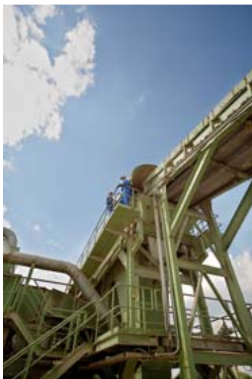
Erst mit dem Förderband nach oben ins Sieb, dann die Feinauslese per Hand: So funktioniert die Baustellenabfallsortierung bei der RAB in Bremen
