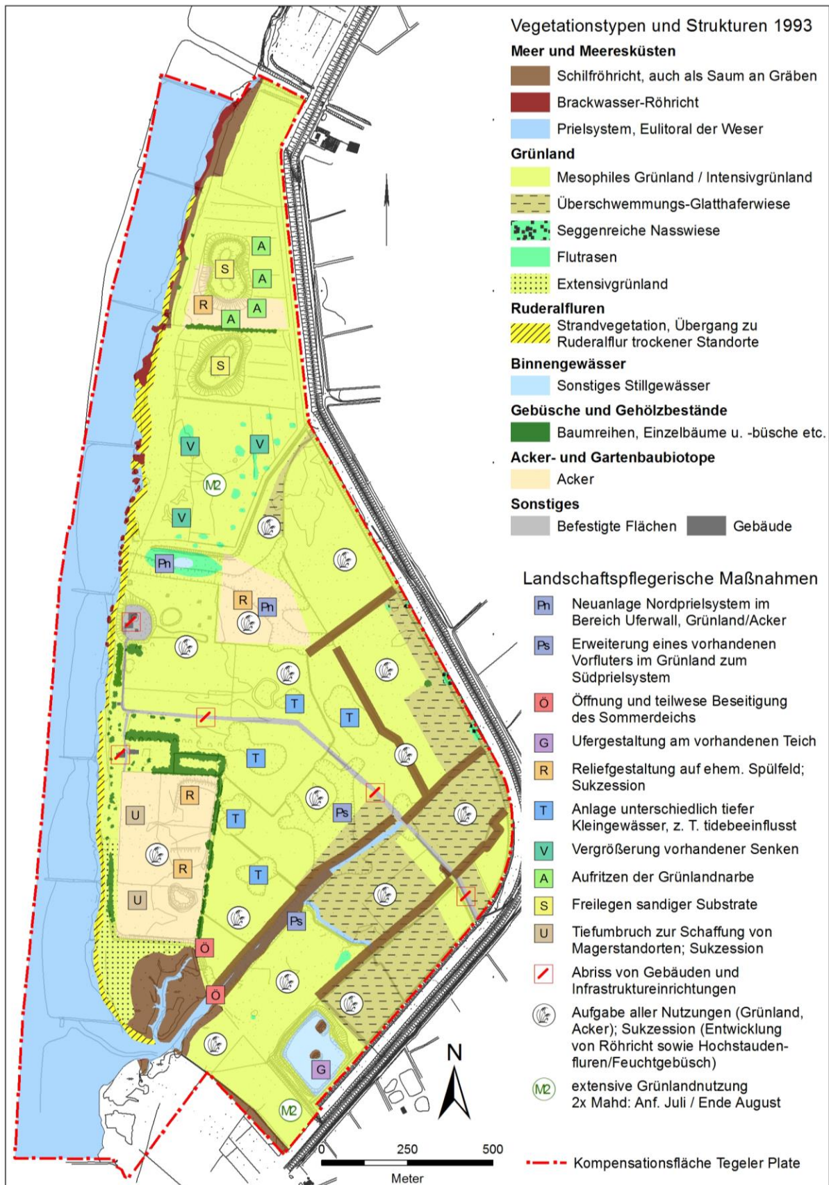
Abb. 4: Ausgangsbestand Tegeler Plate 1993 mit Darstellung der i.R. der baulichen Herrichtung durchgeführten Maßnahmen .
