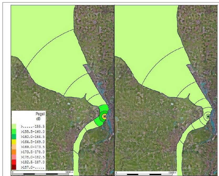
Abb. 10: Wasserschallimmission bei Betrieb einer Vibrationsramme im Weserästuar. Links (Spitzenpegel L_{peak} ), rechts: Sound Exposure Level (SEL); Bilder aus TED (2012).
