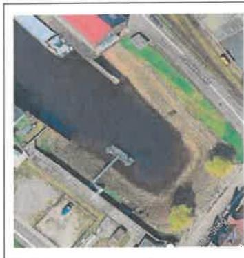
Auf der Nordseite des Hafenbeckens ist das Ufer mit einem Schüttsteindeckwerk gesichert und geht in einen Gründeich über. Eine geschotterte Berme ist hier als Treibselräumweg ausgeführt (s. nebenstehende Abbildung).
