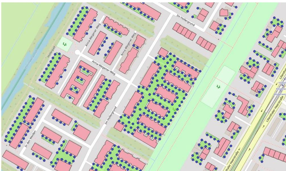
Abbildung 61: Darstellung der Platzierung der EWS auf den Grundstücken für ein Beispielgebiet: Platzierungsbereich auf den Grundstücken (hellgrün); Sondenstandorte (blaue Punkte)
