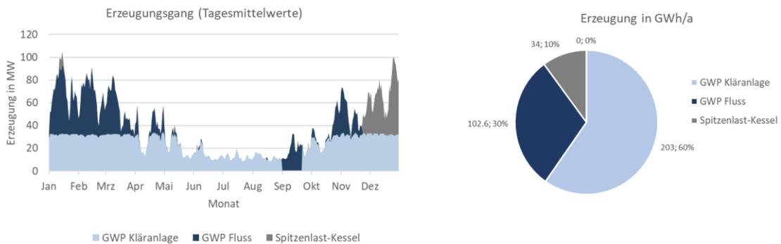
Abbildung 38: Erzeugerkonzept 1 für die neuen Netze 2 bis 5 in Bremen Süd
