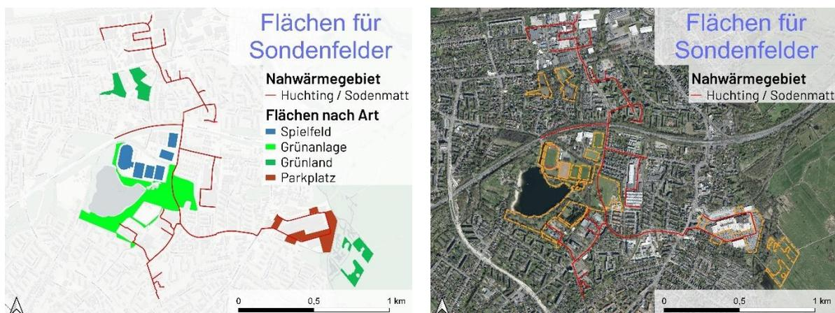
Abbildung 54: Freiflächen in einem Umkreis von 200 m um das potenzielle Nahwärmegebiet Huchting/Sodenmatt, Hintergrund: OSM (links), Digitales Orthophoto DOP20 (rechts)
