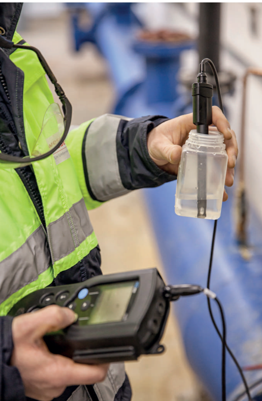
Beprobung des Trinkwassers für die Laboruntersuchung (Quelle: wesernetz Bremen)
