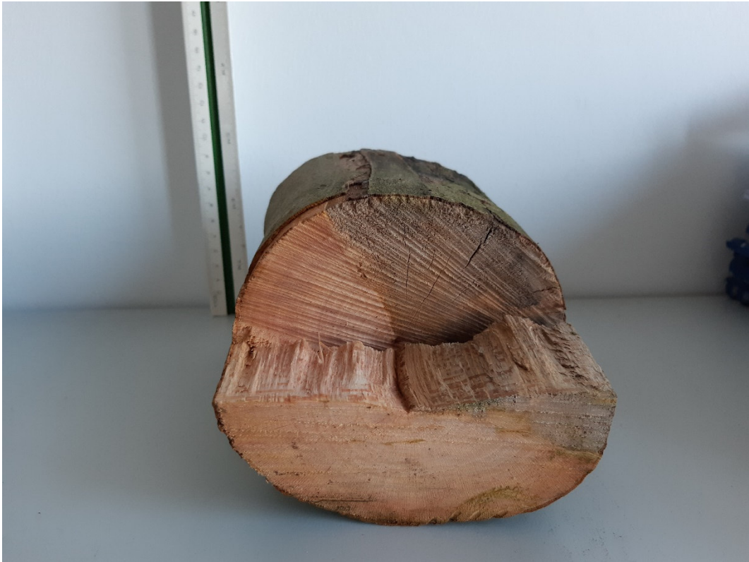
Foto 5: Vor Ort entnommener Astabschnitt mit Pilzbefall (Verdacht auf Massaria)
