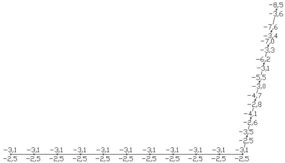
Verformung  $u_z$  nach DIN EN 1992-1-1 (charakteristisch) - min, max Werte
