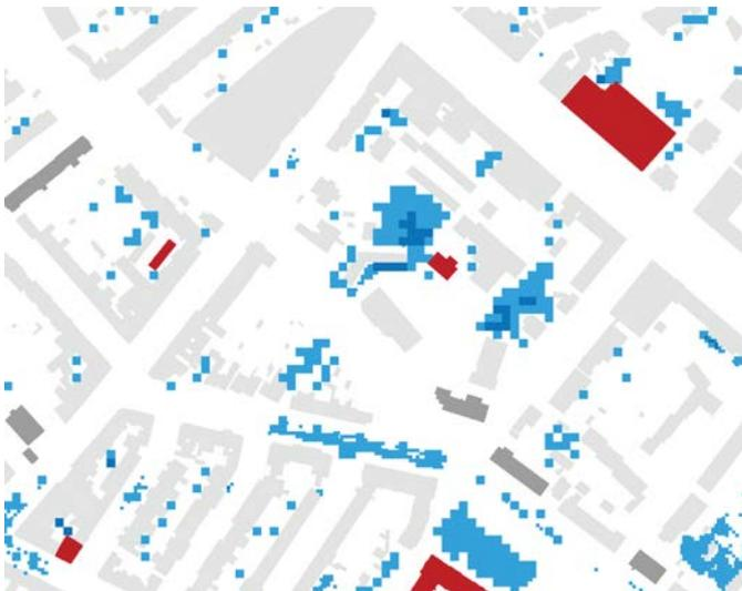
Abbildung 5: Auszug aus der Risikopotentialanalyse für ausgewählte, kritische Infrastrukturen (rot: sensible Einrichtungen, blau: Überflutungsverdachtsflächen)
