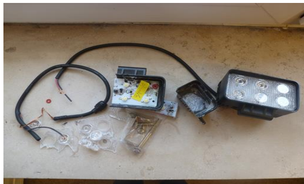
Abb. 14: LED Modul vor und nach der Prüfung
