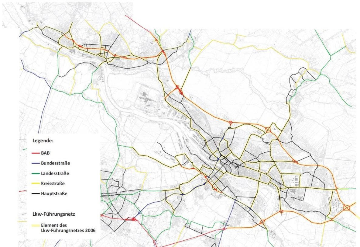
Abbildung 58: Hauptstraßennetz der Stadt Bremen im Jahre 2010 und Darstellung des Lkw-Führungsnetzes [Quelle: Eigene Darstellung, Kartengrundlage: GeoInformation Bremen] (siehe auch Anhang 6.2 Kartenband)
