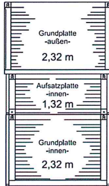
Baugrubentiefe ca. 6,00 m
