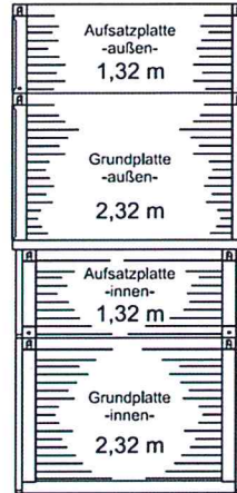
Baugrubentiefe ca. 7,30 m
