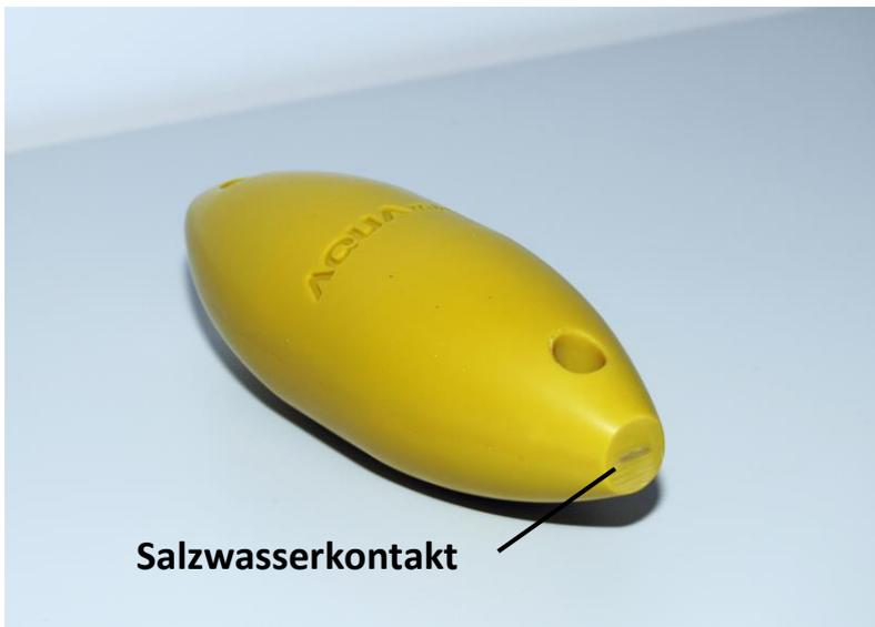
Abb. 5.3 Ein Pinger des Modells AQUAMark 100 mit Maßen von 16 cm Länge und 5.5 cm Breite. Der Pinger hat jeweils an beiden Enden ein Loch um ein Seil daran zu befestigen.
