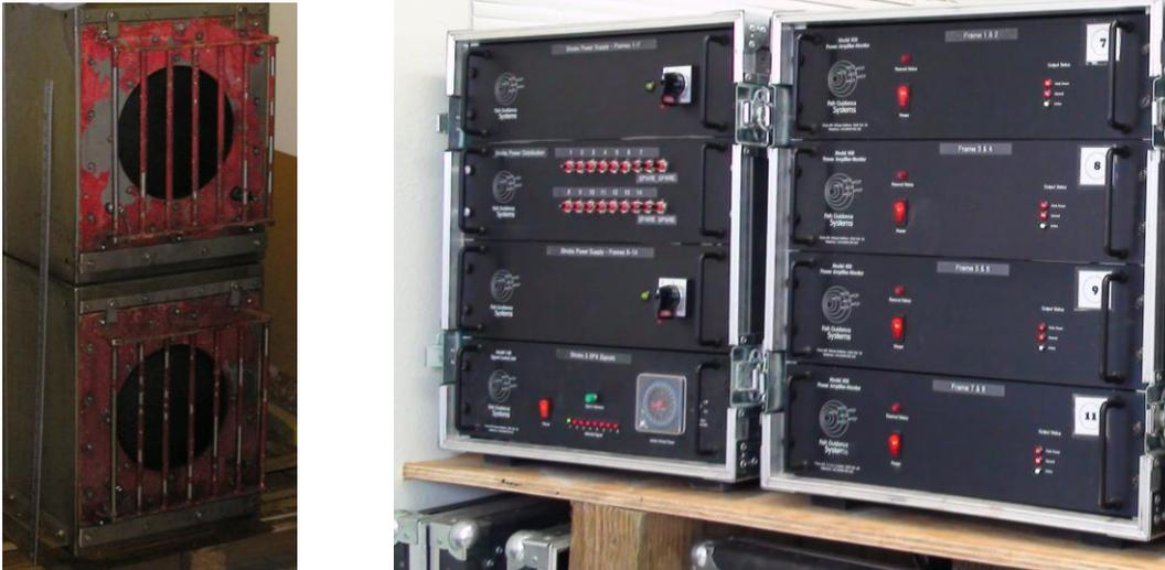
Abb. 5.5 Der akustische Fischvergrämer SPA mit Lautsprecher (links) und Steuerungseinheit (rechts).
