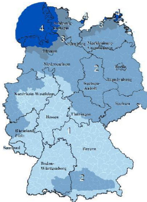
Abb. 8: Windzonenkarte der DIN 1055-4 (DIN 1055-4: 2005-03 Einwirkungen auf Tragwerke – Teil 4: Windlasten)
