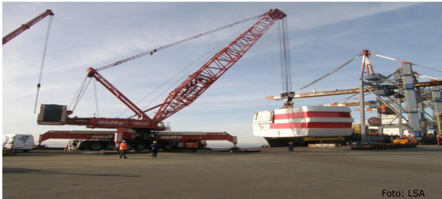
Umschlag eines 5MW-Maschinenhauses im Containerterminal Bremerhaven im Vergleich mit einem Airbus 380-Segment
