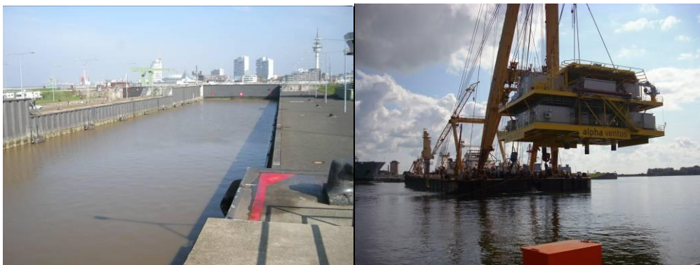
Abb. 2.4.2.1 : Schwimmkran Taklift 4 im Schleusenhafen Wilhelmshaven bei Verladung einer Topside auf einen Ponton
