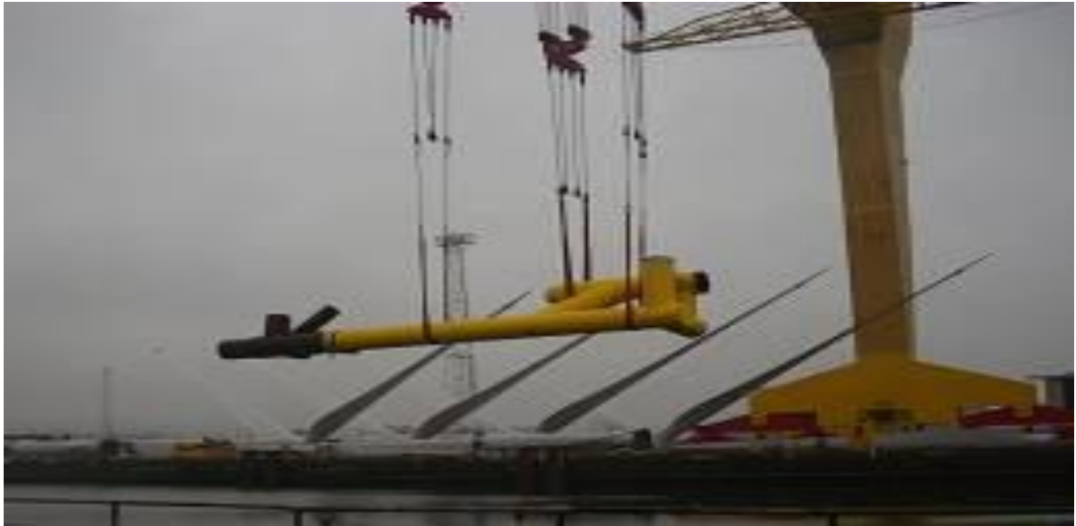
Abb. 2.5.4. Anforderungen an den Umschlag und die Lagerung im Offshore-Hafen - Beispiel: 3MW-Maschinenhaus mit zwei vormontierten Rotorblättern in Belfast. Im Vordergrund Umschlag einer Komponente für die Gründungsstruktur einer Trafostation (153 to, 33m Länge) eines deutschen Projektes.
