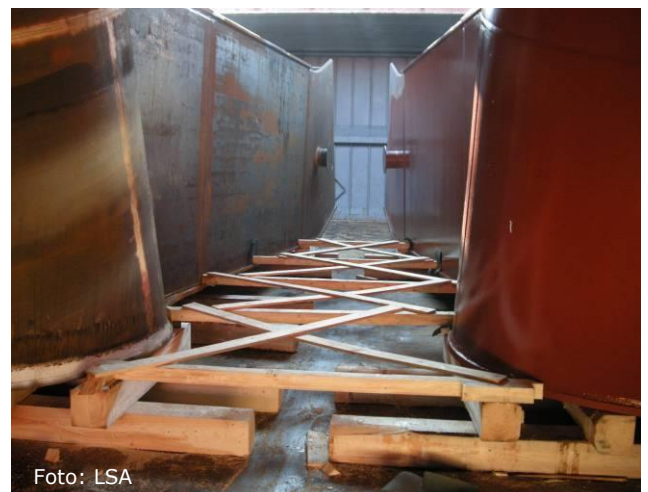
Abb. 2.4.2.3 Erheblicher Aufwand für Stau- und Laschaufwand auch für kurze Transporte über die Seeschiffahrtsstraßen. Anteil ca. 60 Prozent der Gesamtkosten
