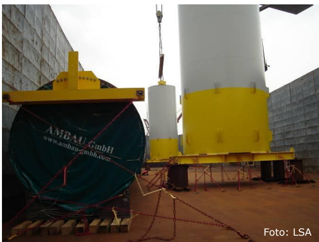
Abb. 2.4.2.3 Erheblicher Aufwand für Stau- und Laschaufwand auch für kurze Transporte über die Seeschiffahrtsstraßen. Anteil ca. 60 Prozent der Gesamtkosten
