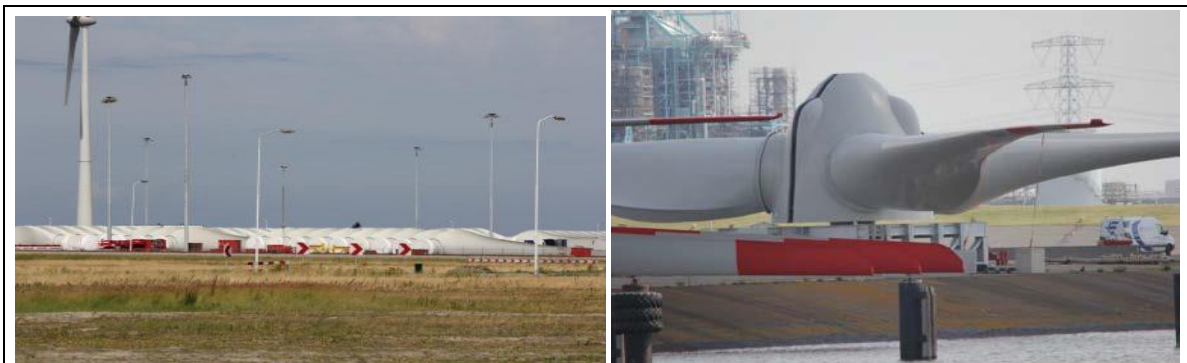
Abbildung 20: Rotorstern und Blattlager im Hafen von Eemshaven
