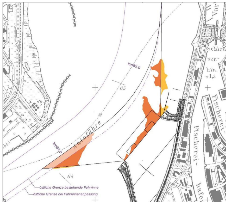
Abb. 4: Sublitoralbereiche, die zur Herstellung der Sohltiefe gebaggert werden müssen;
