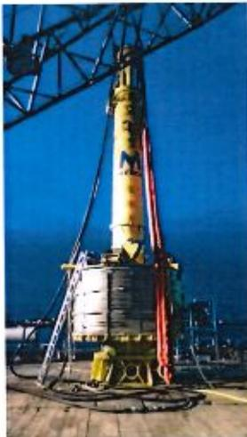
**Abbildung 18: Ausrüstung einer Schlagramme mit Faltenbalg**
