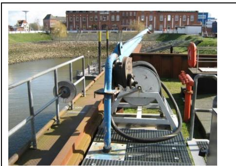
Direkt an der HWS-Wand steht eine Trommel mit entsprechender Schlauchleitung für den Anschluss an das Schiff. In diesem Bereich legt derzeit ausschließlich ein Schiff mit einer Länge von 25,08 m, einer Breite von 4,61 m und einem Tiefgang von 1,60 m an.
