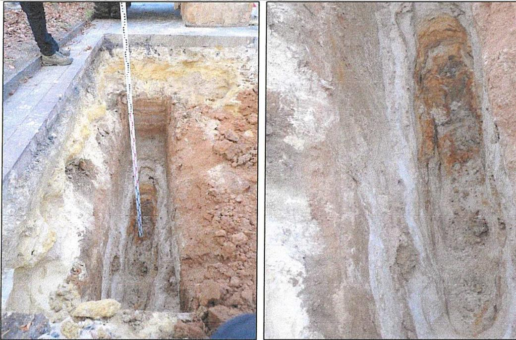
Es sind keine Wurzeln im oberflächennahen Sandboden mit darunter vorhandenem, dichtem Lehmkörper bis ca. 2,2 m Tiefe vorhanden.
