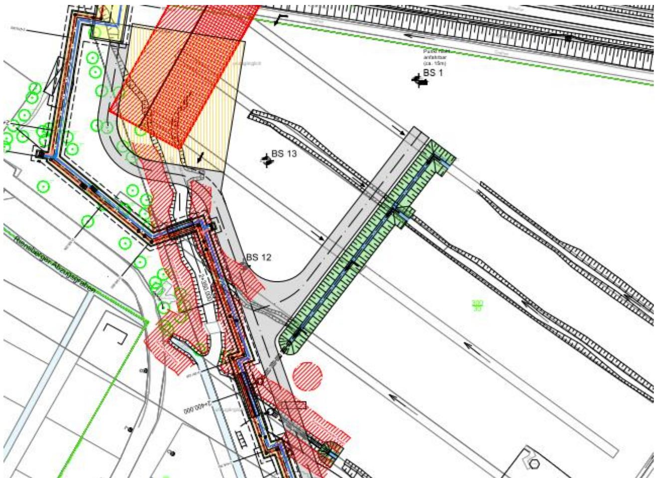
Abb. 6-10: Zusammenführung untergeordneter Entwässerungsgräben (2)
